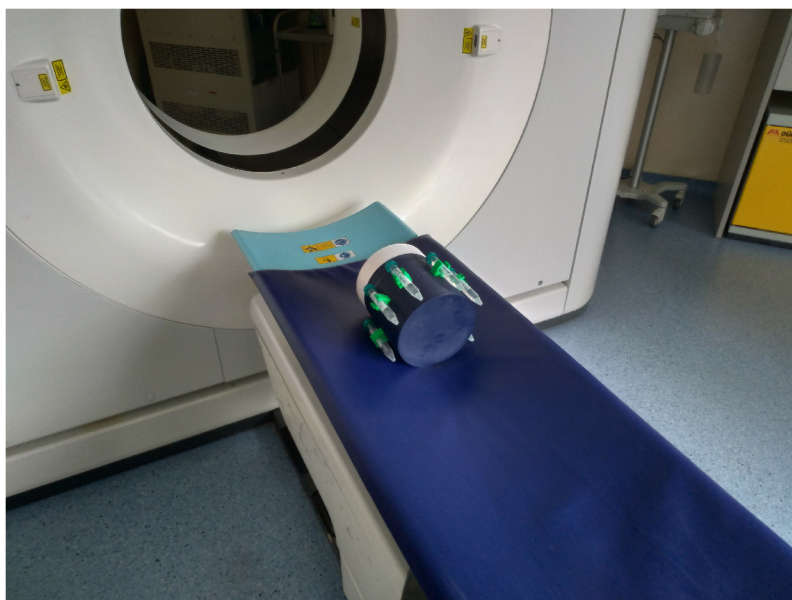
Obr. 6.3: Nastavení hlavového fantomu
