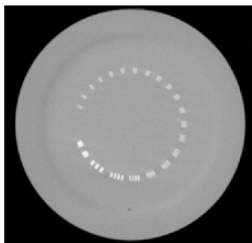
Obr. 2.3: Měření rozlišení při vysokém kontrastu [5]
