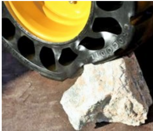
Obrázek 10: Deformace nových pneumatik se silnými radiálními lamelami [12]
