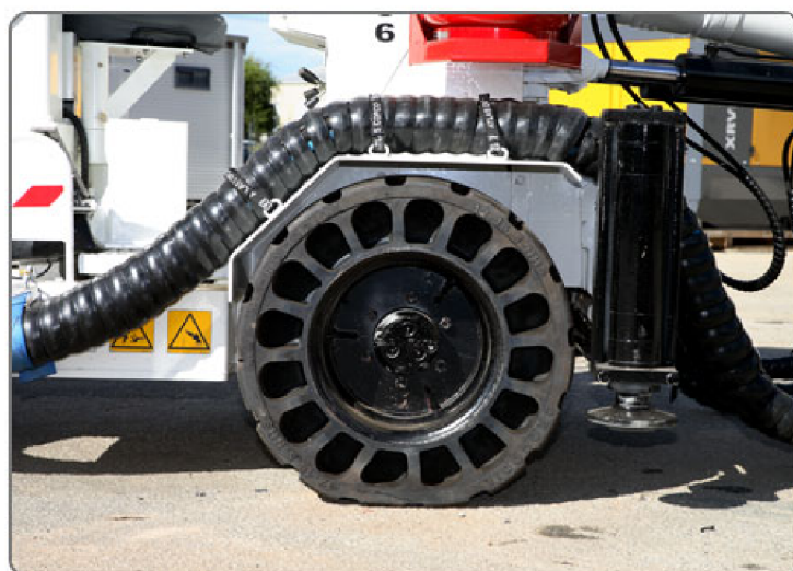
Obrázek 1: Crocodile Tire - NPT pneumatika s nízkou schopností pružení [3]
