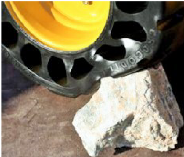
Obrázek 10: Deformace nových pneumatik se silnými radiálními lamelami [12]
