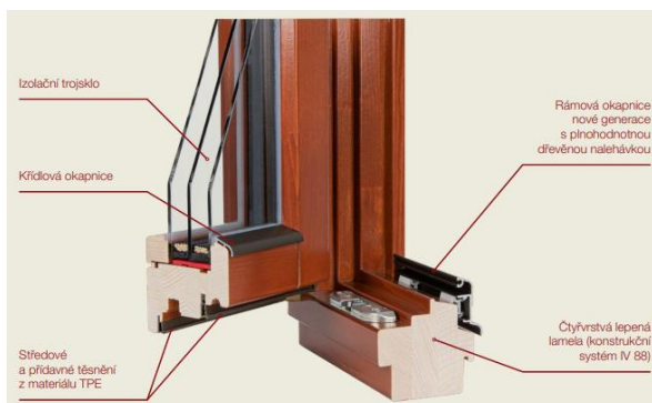
Obrázek 13 Skladba dřevěného rámu okna výrobce PKS [61]
