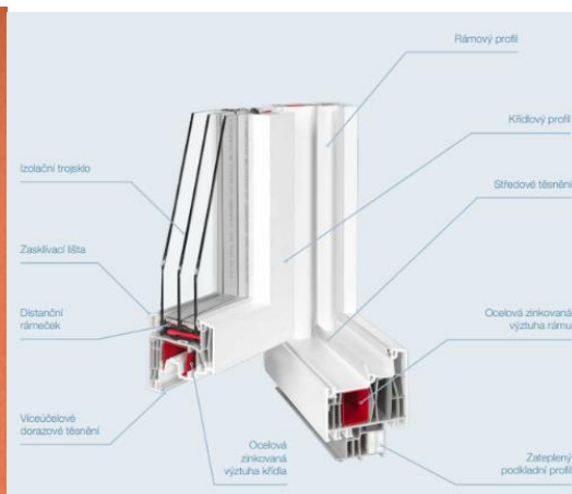
Obrázek 11 Skladba plastového rámu okna výrobce PKS [60]
