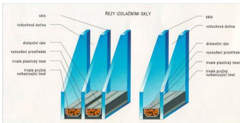
Obrázek 17 Řez izolačními skly [66]
