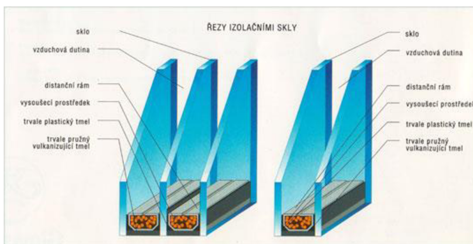
Obrázek 17 Řez izolačními skly [66]
