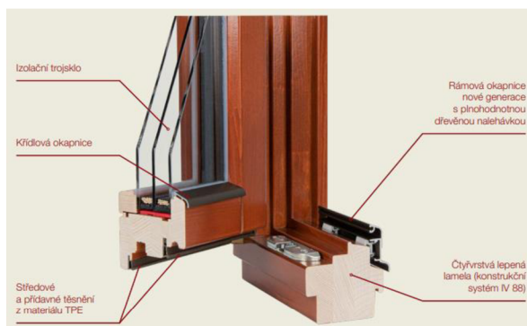
Obrázek 13 Skladba dřevěného rámu okna výrobce PKS [61]
