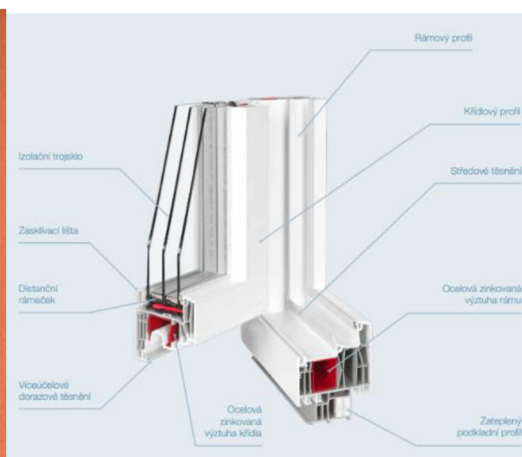
Obrázek 11 Skladba plastového rámu okna výrobce PKS [60]
