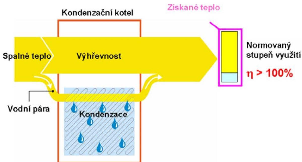
Obr. 3 Schéma principu získávání latentního tepla [11]
