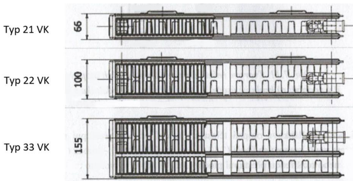
Obr. 2 Přehled základních typů deskových otopných těles [3]
