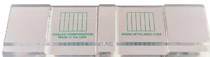
Obrázek 3.3 McMasterova počítací komůrka (vlastní zdroj)
