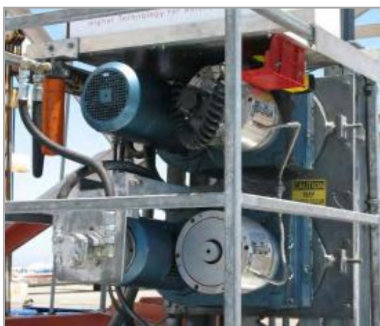
Obr. 9 Pohon hřebenového výtahu [30]
