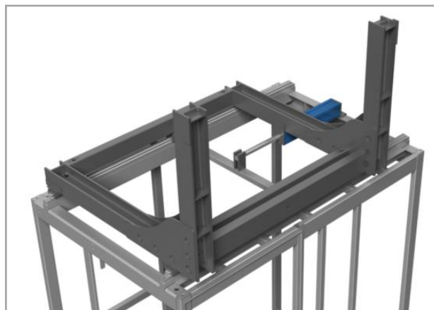
Obr. 42 Pneumatický pohon – pneumatickým válcem
