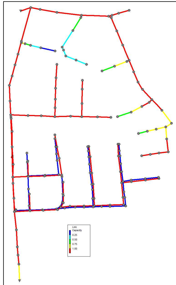
Obr. 4.33. Kapacita potrubí stokové sítě při N5, 8. minuta
