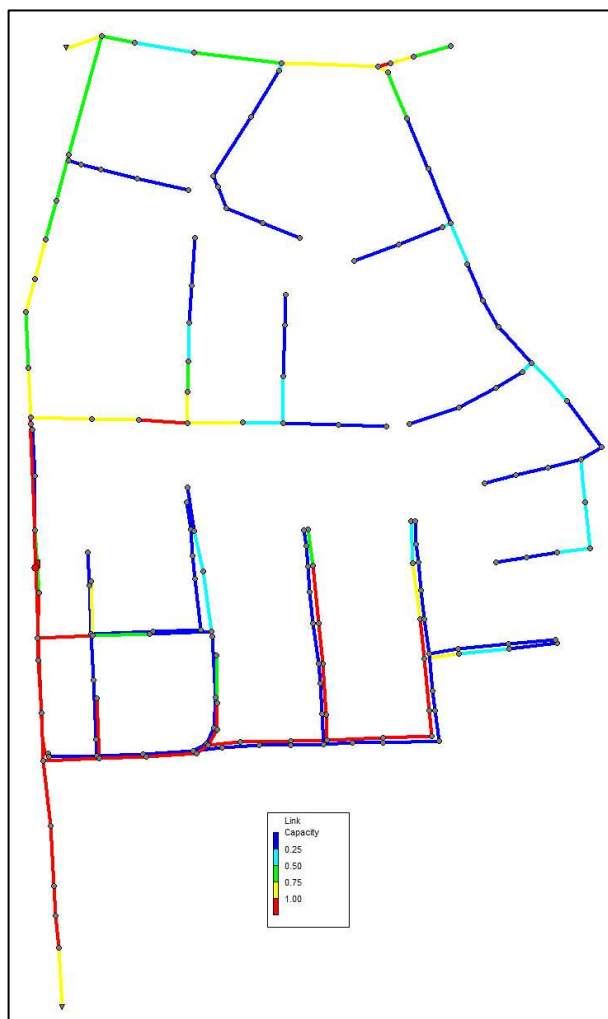
Obr. 4.45. Kapacita potrubí stokové sítě při N2, 16. minuta
