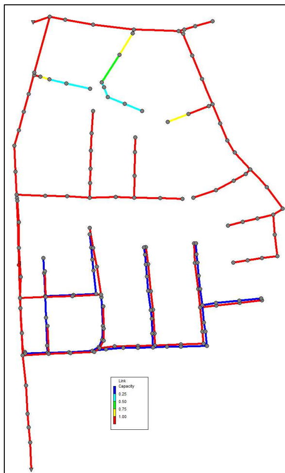
Obr. 4.34. Kapacita potrubí stokové sítě při N20, 16. minuta
