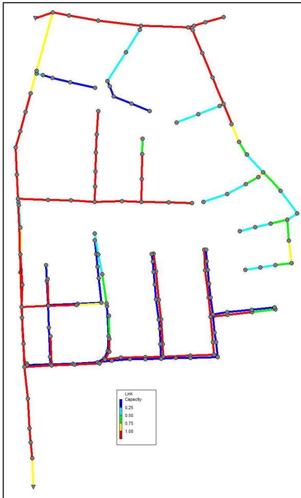
Obr. 4.32. Kapacita potrubí stokové sítě při N2, 10. minuta
