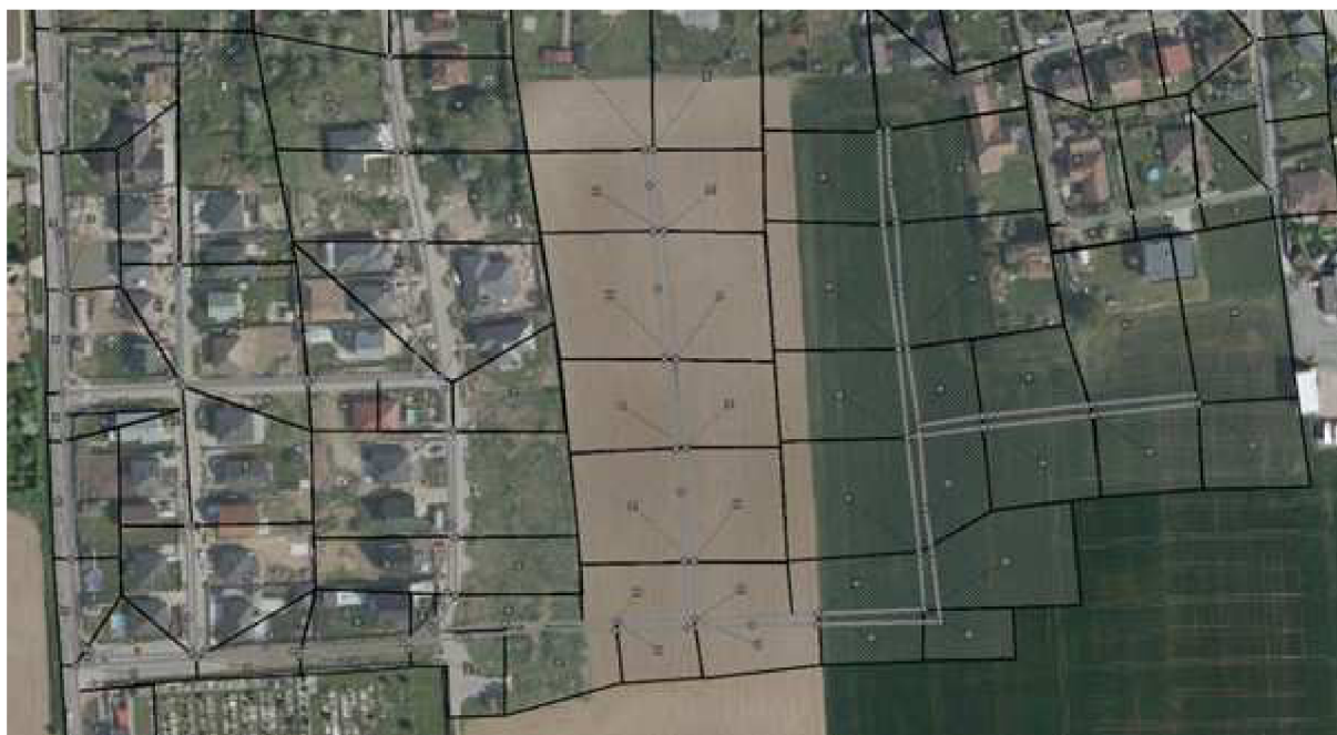
Obr. 4.22. Výřez z modelu plánovaného rozvoje pro znázornění odtokových ploch a stokové sítě
