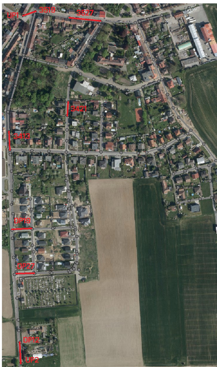
Obr. 4.4. Mapa stokové sítě s umístěním sledovaných úseků
