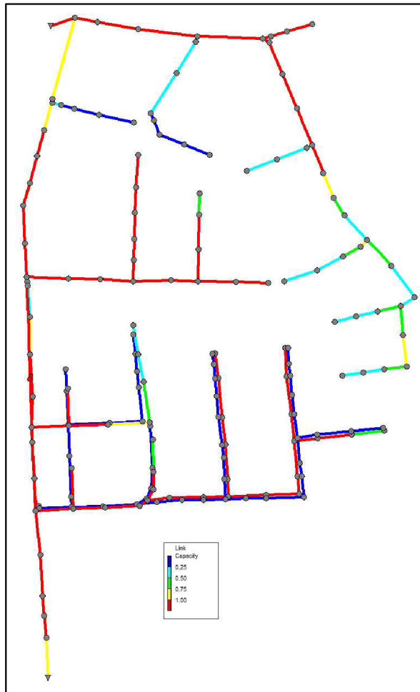
Obr. 4.32. Kapacita potrubí stokové sítě při N2, 10. minuta
