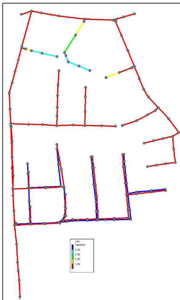
Obr. 4.34. Kapacita potrubí stokové sítě při N20, 16. minuta
