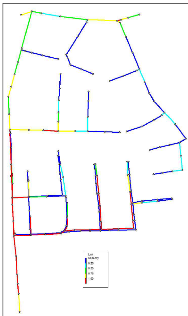
Obr. 4.45. Kapacita potrubí stokové sítě při N2, 16. minuta
