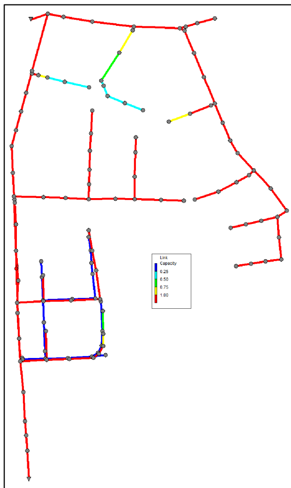
Obr. 4.20. Kapacita potrubí stokové sítě při N20, 15. minuta
