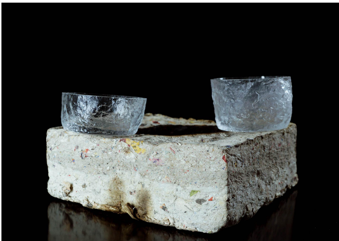
Obrázek 11.: Ukázka struktury experimentální techniky foukání skla do recyklované formy z “papírmaše”, sada užitkového skla PAPIR
