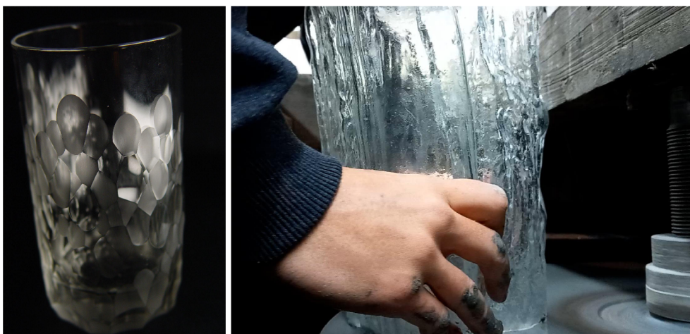
Obrázek 25.: Rozdíl textur leštěného a neleštěného povrchu na sklenici
