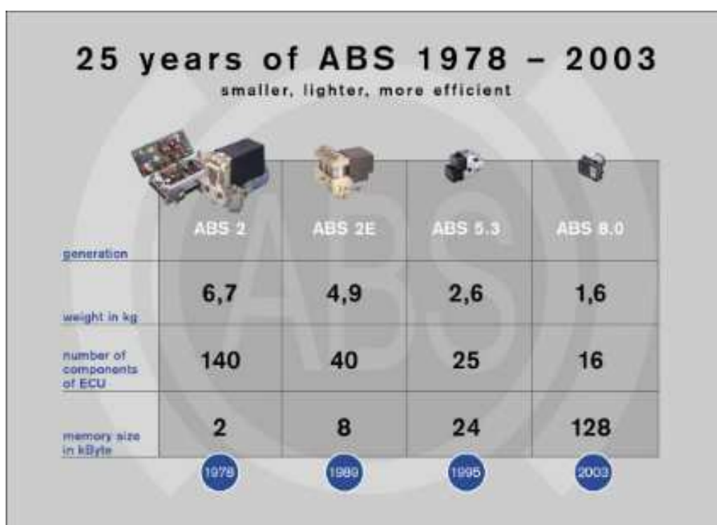
Obr. 2 vývoj a miniaturizace systému ABS
