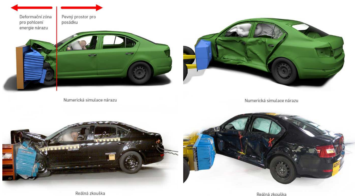
Obr. 15 Testování deformačních zón: počítačová simulace (nahore) vs. reálná zkouška (dole)
