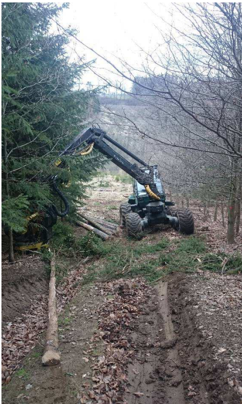
Obr. 7 a 8: - Na fotografiích můžeme vidět, že se operátor harvestoru snaží za pomoci klestu zvýšit adhezi pneumatik na kluzké lince, kterou nemohl vyjet.
