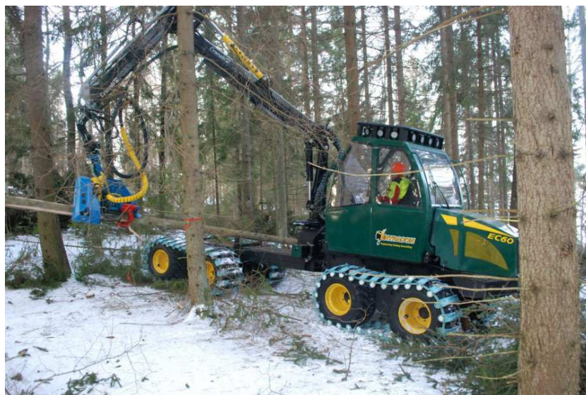
Obr. 1: Harwarder ENTRACON EC60 při práci s kácecí hlavicí (www.entracon.cz, 20.4. 2016).
