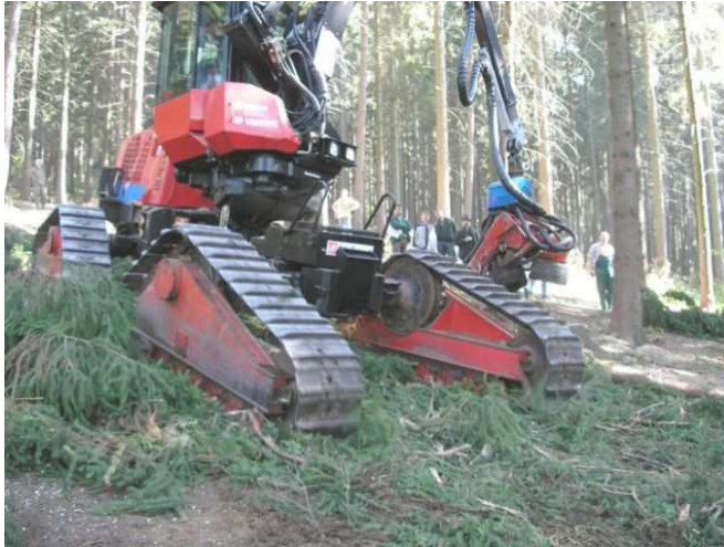
Obr. 2: Harvester Valmet (Komatsu) s pásovým podvozkem
