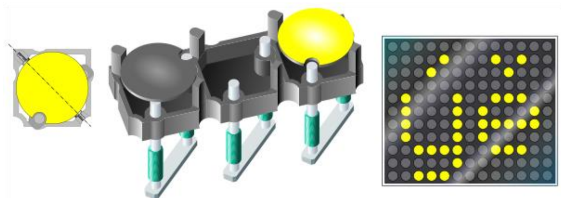
Obr. 1.7 Vzhled a princip funkce terčikového displeje [6]
