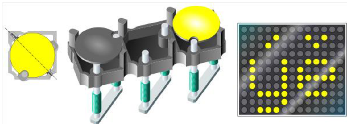
Obr. 1.7 Vzhled a princip funkce terčikového displeje [6]
