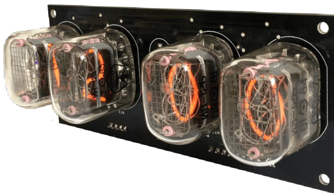
Obr. 1.8 Příklad využití digitronů jako zobrazovače hodin [12]
