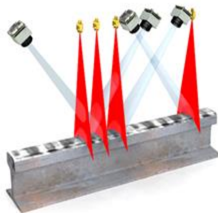
Obr. 31 Příklad nejčastějšího způsobu měření na měřícím vozidle – přímou bezkontaktní metodou: Systém používá pro měření na kolejnicovém pásu čtyři lasery a kamery vytvářející čtyři optické asymetrické tětivy. [46]
