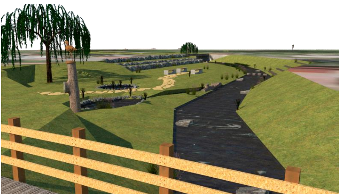
Obrázek 10: Po renderování v programu V-Ray, slepé rameno, tůň, zpevněný břeh u mostu.
