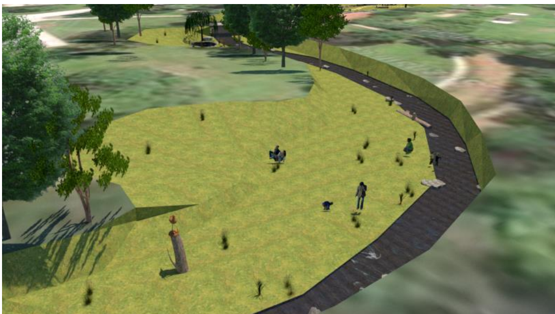
Obrázek 5: Detail prostředního úseku, břehy snižené, vytvoření odpočinkové zóny a prostoru pro rozliv Bartošovického potoka.
