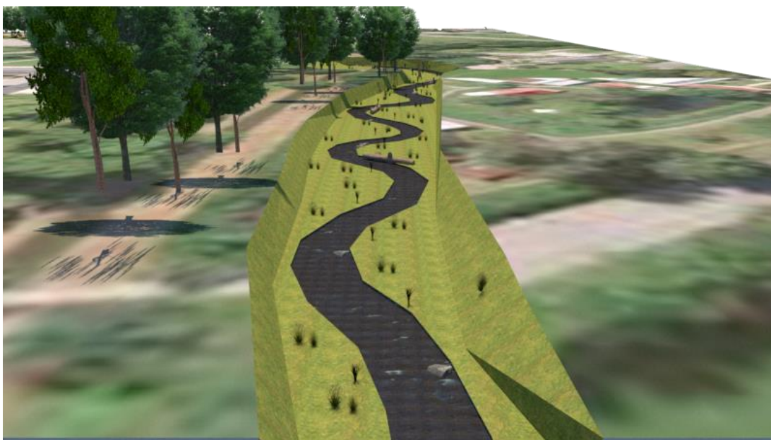
Obrázek 4: Detail začátku úseku 1, rozšířené koryto, prostor pro meandry.
