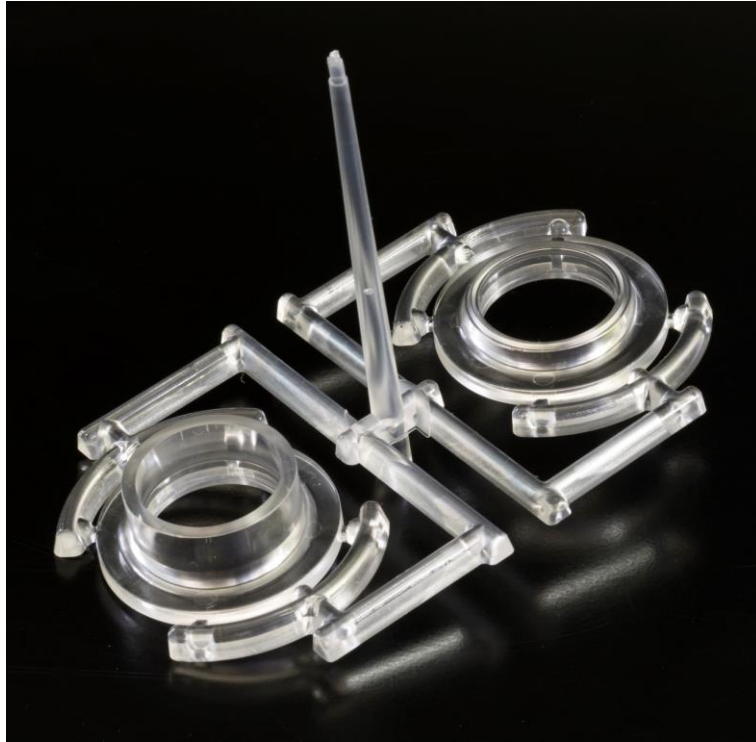
Obr. 4.38 Kompletní výlisek po vyhození z formy
