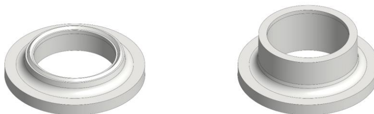
Obr. 3.1 Vstřikované díly (zkušební těleso DVS)
