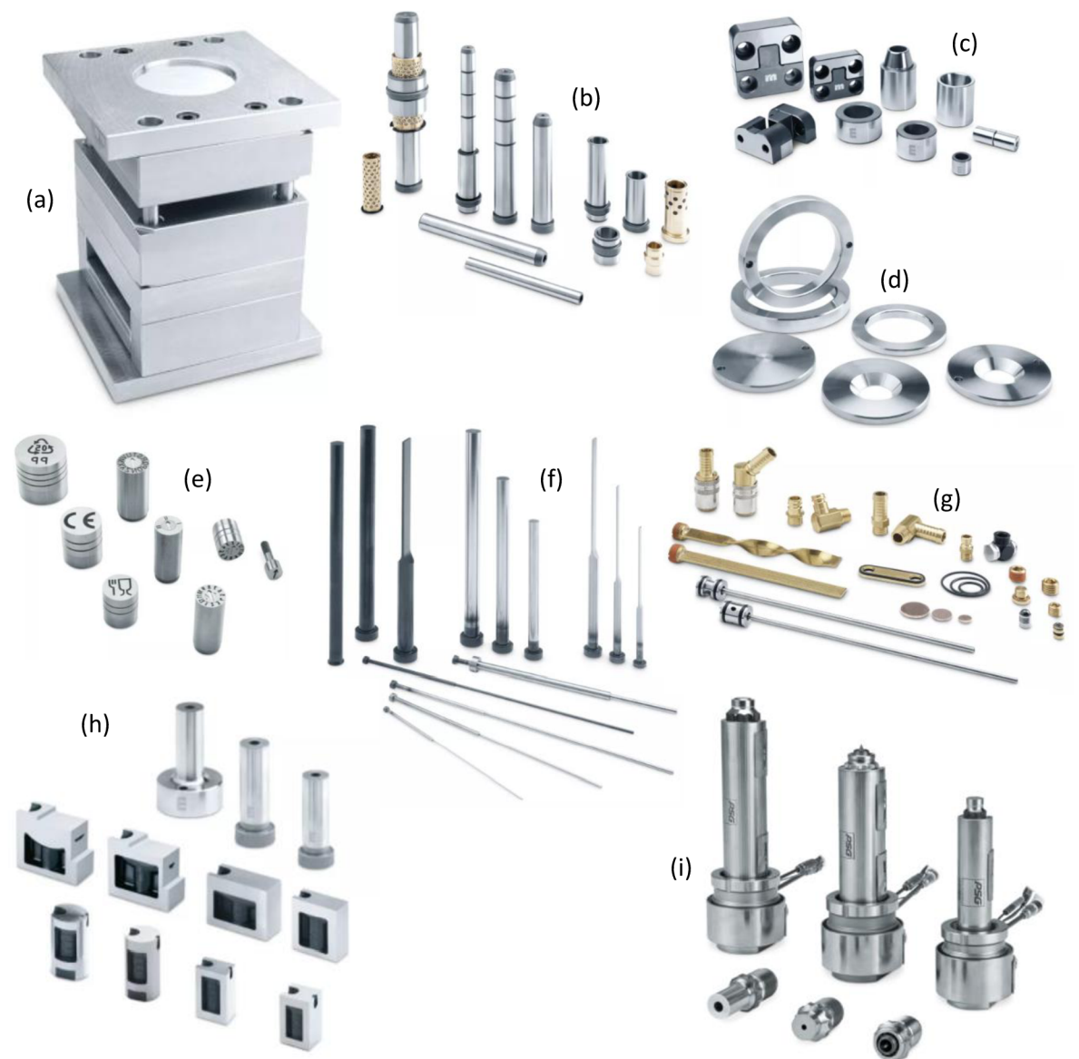
Obr. 2.22 Standardizované komponenty a normálie od firmy Meusburger Georg GmbH & Co KG, (a) rám formy, (b) vodící elementy, (c) středící elementy, (d) středící kroužky, (e) vložky do datumovek, (f) vyhazovače a jádra, (g) prvky chladicích systémů, (h) vtokové vložky, (i) komponenty pro horké vtoky [14]
