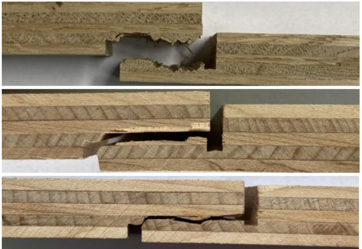
Obr. 39 - Typické lomy po zkoušce na smykovou pevnost v lepeném spoji
