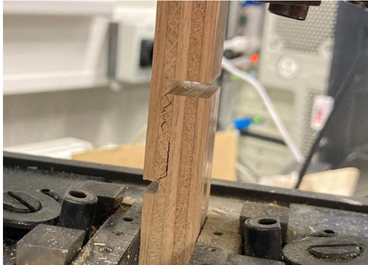
Obr. 38 - Lom v pětivrstevném materiálu z dubu v trhacím stroji
