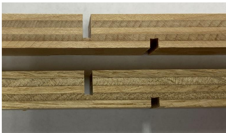
Obr. 29 - Prořez na zkušebních těles (nahore javor, dole dub)
