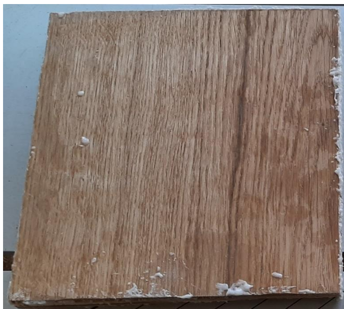
Obr. 21 - Překližovaný materiál po lisování
