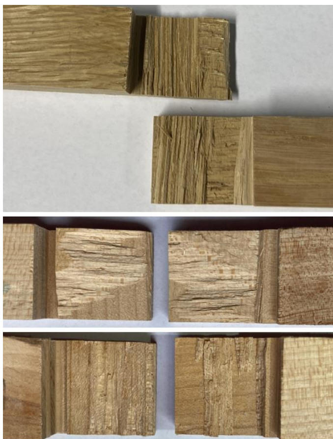
Obr. 40 - Typické lomy v ploše lepeného materiálu
