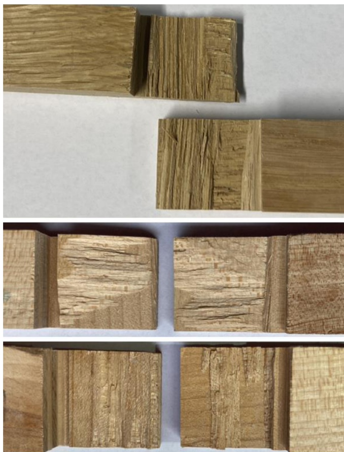
Obr. 40 - Typické lomy v ploše lepeného materiálu
