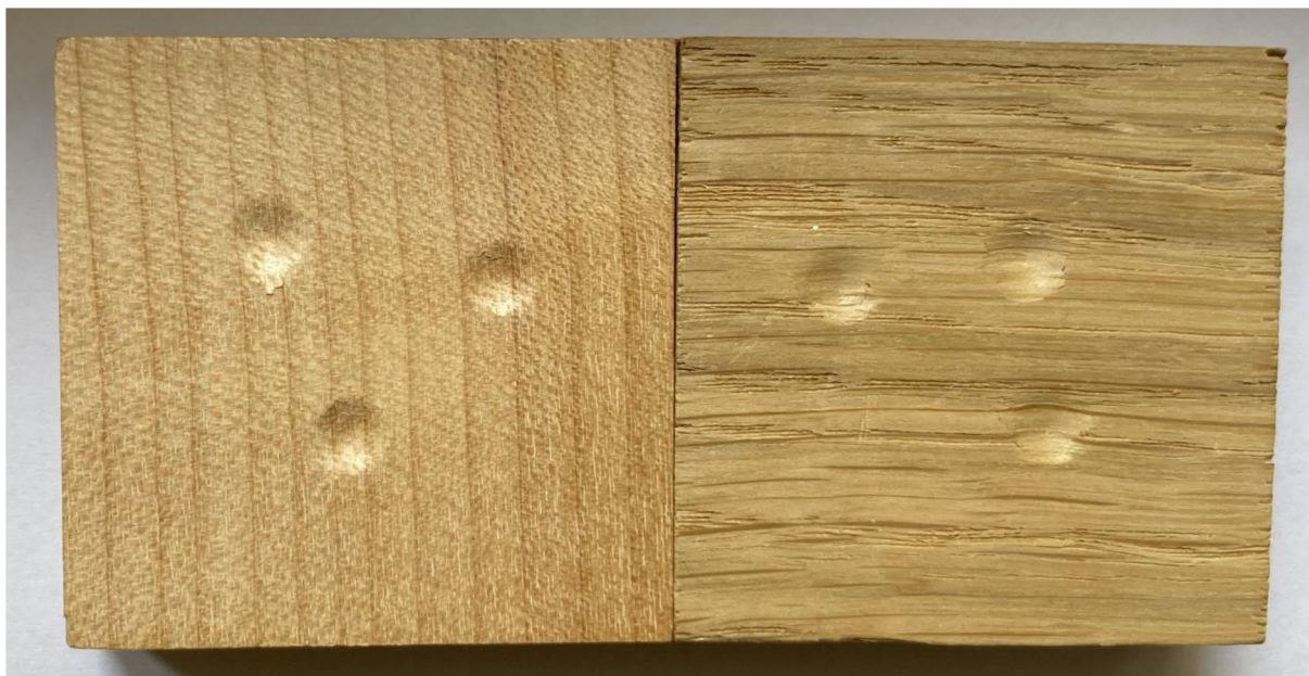
Obr. 44 . Pětivrstvý překližovaný materiál z javoru (vlevo) a dubu (vpravo) po zkoušce tvrdosti podle Brinella
