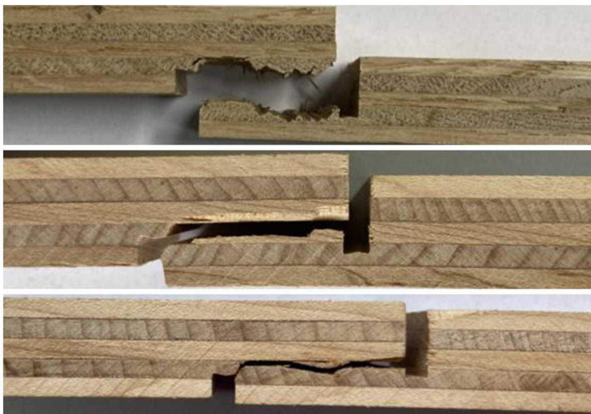
Obr. 39 - Typické lomy po zkoušce na smykovou pevnost v lepeném spoji
