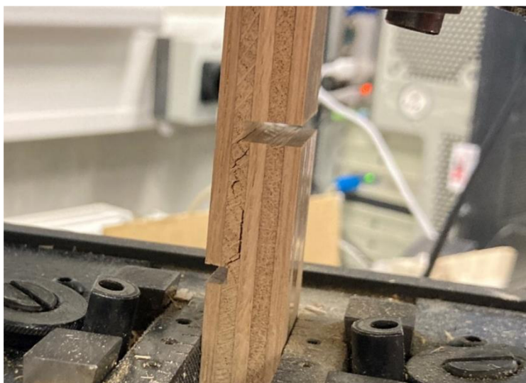
Obr. 38 - Lom v pětivrstevném materiálu z dubu v trhacím stroji
