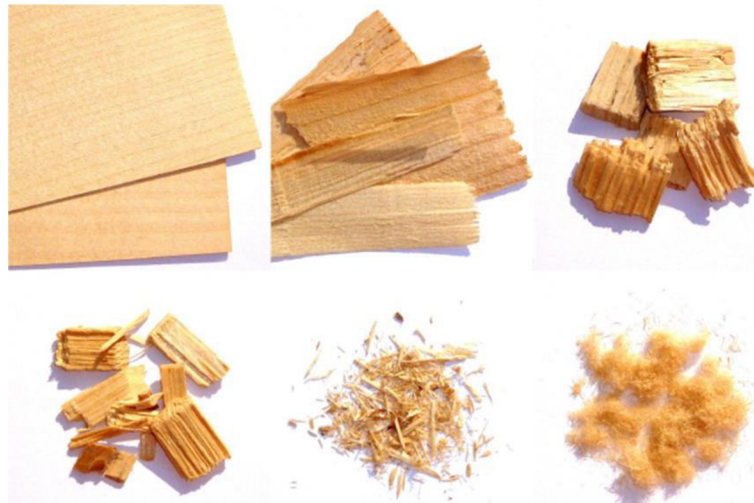
Obr. 6 - Nejčastější typy frakce pro výrobu materiálů na bázi dřeva (Böhm 2012) (zleva shora: dýhy, velké ploché třísky pro výrobu OSB, bílá (papírenská) štěpka, štěpka pro výrobu třísek a vláken, třísky, vlákna).
