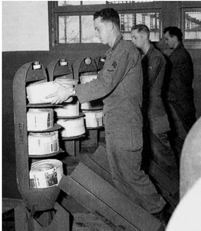
Obrázek 4: Rolka propagandistických letáků vkládána do dělostřeleckého projektilu
