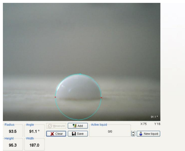
Obrázek 26 – Schéma měření kontaktního úhlu u kapky lepidla na povrchu dřeva, detail analýzy provedené systémem „SEE Software“
