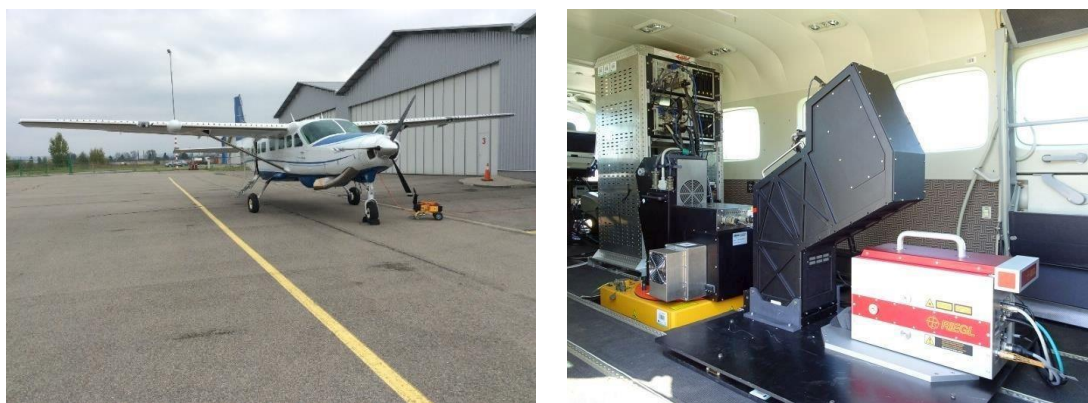
Obr. 12 Letadlo Cessna 208B Grand Caravan (vlevo), hyperspektrální sensory CASI-1500, SASI-600, TASI-600 včetně laserového skeneru Riegl LMS-Q780 instalované v kabině letadla (vpravo) (Hanuš et al. 2017)
