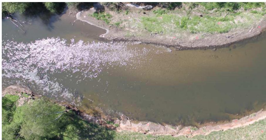
Obr 6.11 Třpyt na snímku způsobený odraženým slunečním zářením a zvlněnou lesklou plochou (foto: J. Miřijovský).
