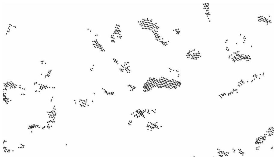
Obr. 8.4 Ukázka nerovnoměrného rozložení bodů v terénu (autor: J. Miřijovský).
