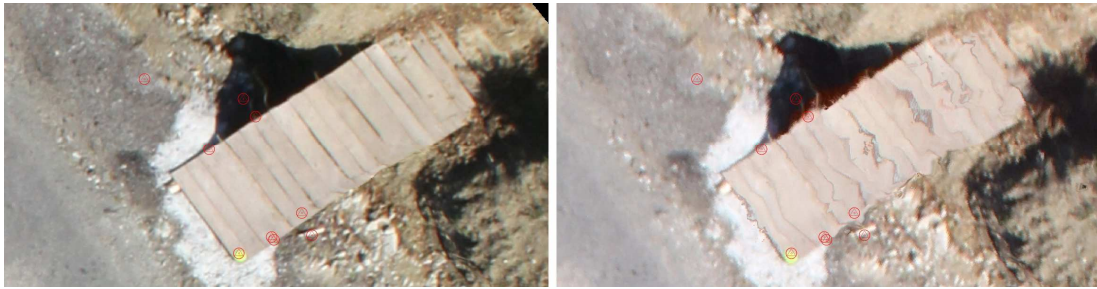
Obr. 12 Vizuální rozdíl vybraného detailu v ortogonalizovaných snímcích z metody SfM (vlevo) a stereofotogrammetrie (vpravo).
