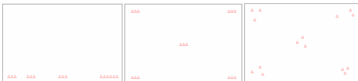
Obr. 7.5 Různé varianty rozmístění vlčovacíh bodů (autor: J. Miřijovský).
