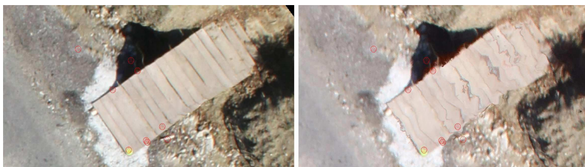
Obr. 9.3 Vizuální rozdíl vybraného detailu v ortogonalizovaných snímcích z metody SfM (vlevo) a stereofotogrammetrie (vpravo) (autor: J. Miřijovský).
