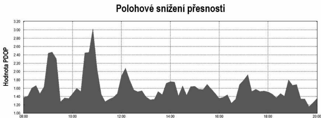
Obr. 7.7 Plán měření v programu Trimble Planning (autor: J. Miřijovský).
