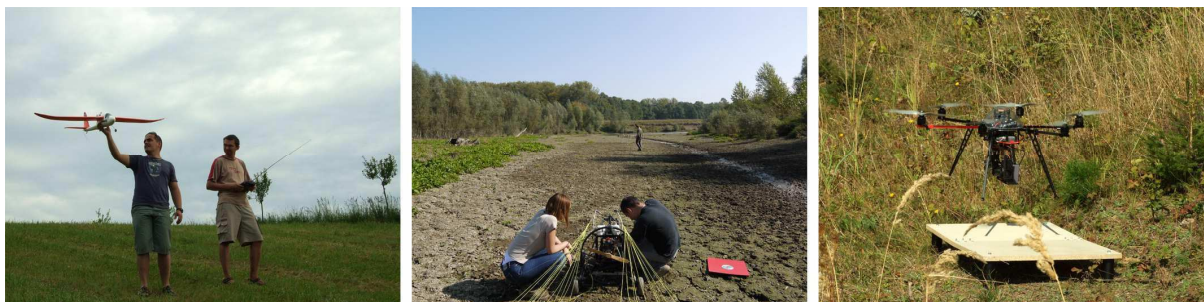
Obr. 7.9 Typy startů: hozením z ruky (vlevo), rozjetím po startovací dráze (uprostřed), kolmý start (vpravo) (foto: J. Svobodová, S. Popelka).
