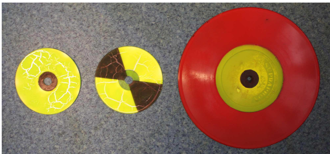
Obr. 7.1 Různé typy terčů používané jako vlčovací body (foto: J. Miřijovský).
