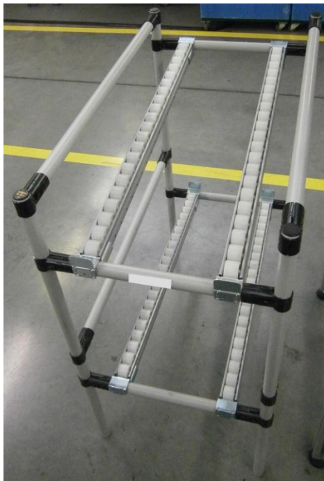
Ilustrace trubkového systému zásobníku materiálu dané firmy [4].
