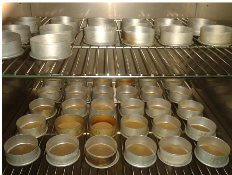
Obr.č.2 Vzorek je rozprostřen v tenké vrstvě a sušen v otevřené váženě
