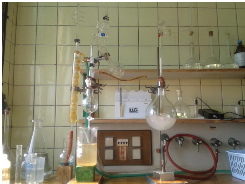
Obr. č. 4 Destilační aparatura dle Parnase-Wagnera
