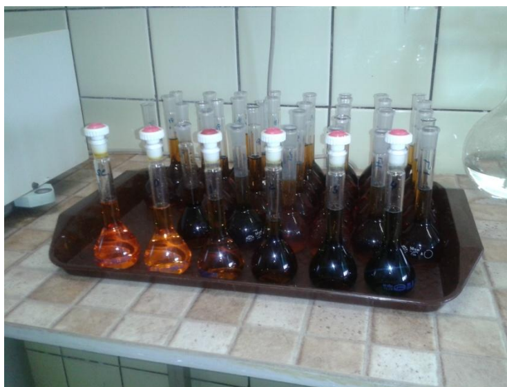
Obr.č.3 Přefiltrované a doplněné vzorky připravené k měření absorbance
