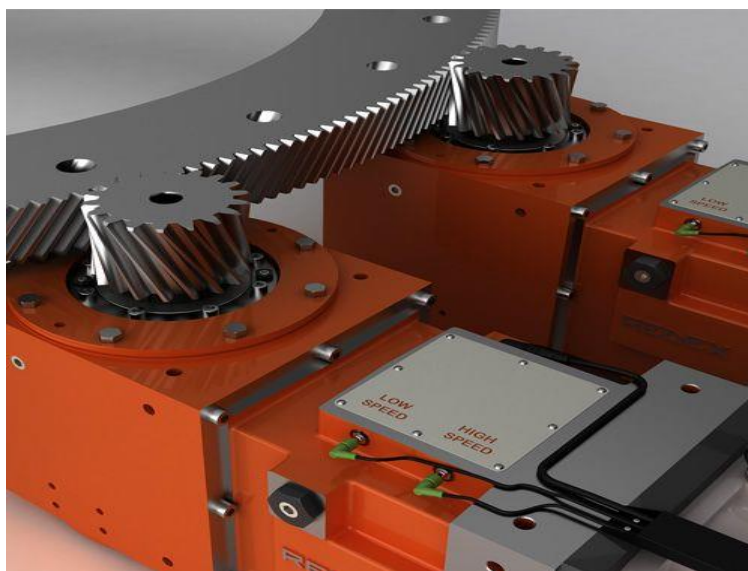
Obr. 5) Pohon věnce otočného stolu dvěma pastorky s šikmým ozubením [9]
