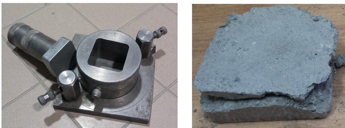
Obr. 19 Kovová forma a porušený vzorek
