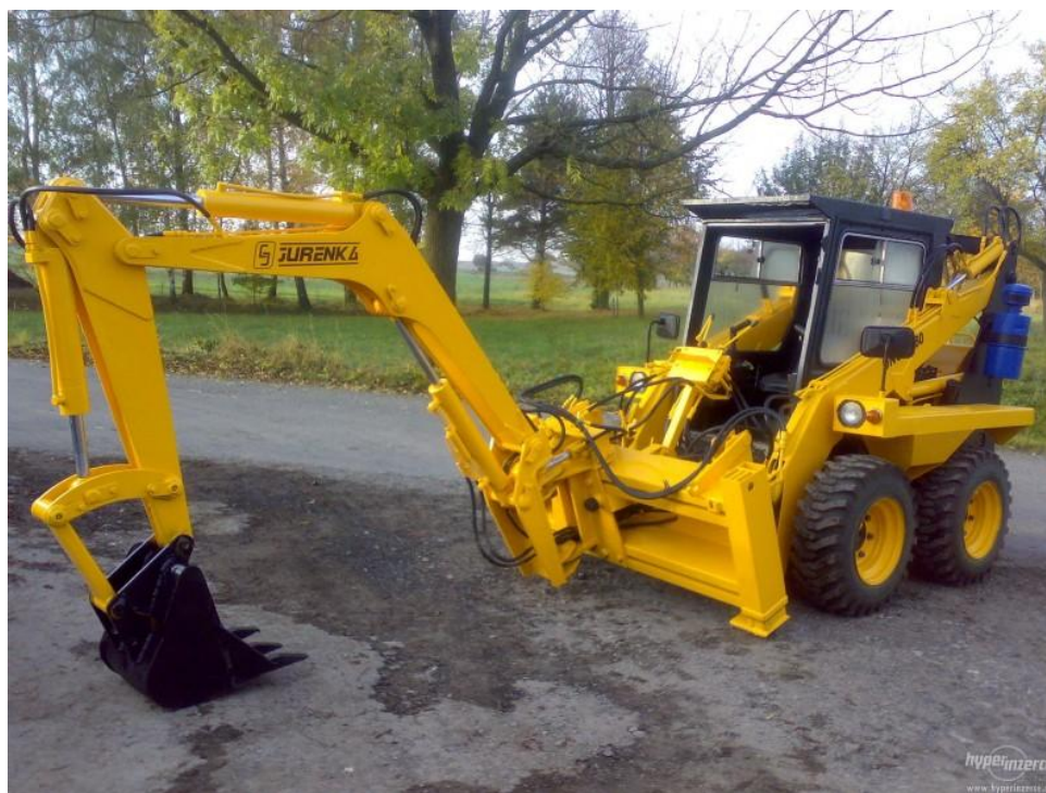
Obr. 1.3 Přídavné zařízení pro smykem řízený nakladač – rypadlové zařízení [9]
