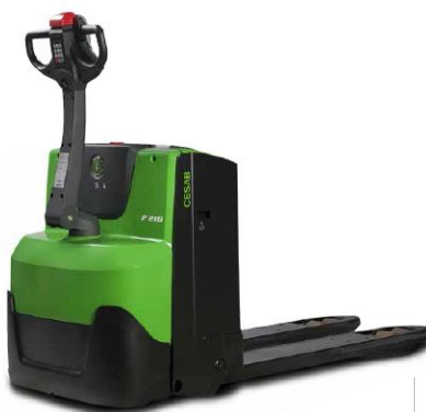
Obrázek 4 Nízkozdvižný ručně vedený vozík Cesab P216
