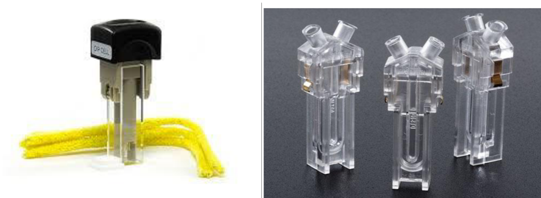
Obr. 24 Dip cela (vlevo) [146], DSC 700 cela (vpravo) [147]
