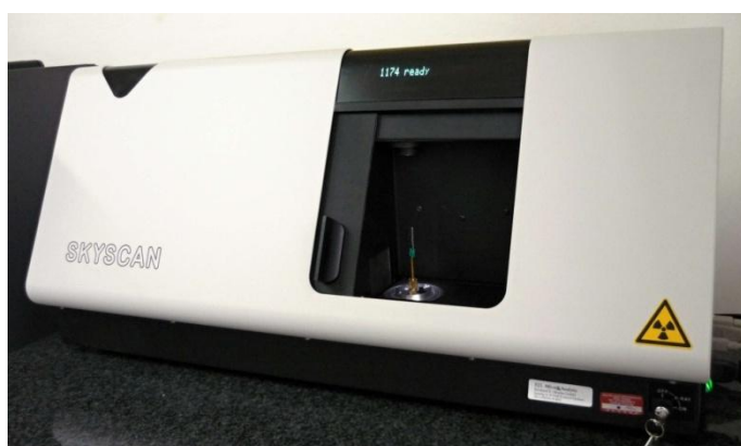
Obr. 17 Přístroj SkyScan 1174 pro analýzu pomocí micro CT [27]
