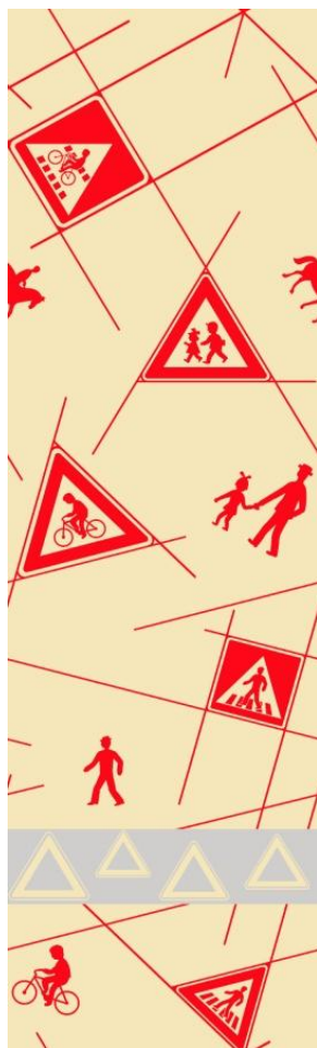
Obr. 50 Střída vzoru výsledné tkaniny v pracovních barvách (světlá barva=barevný, červená=luminiscenční a šedá=retroreflexní útek) - lící strana
