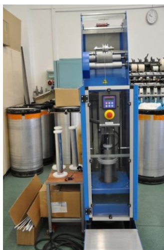
Obr. 25 Prstencový skací stroj [35]
