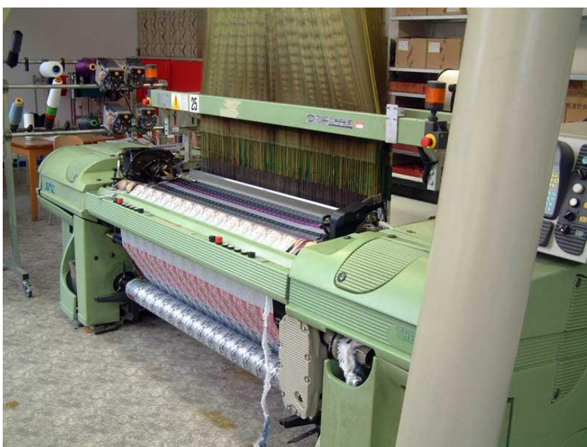
Obr. 49 Tkací stroj Somet Thema 11 Excel firmy Stäubli
