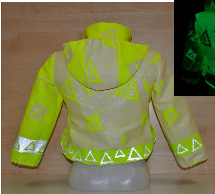
Obr. 71 Zadní díl bundy za denního osvětlení Obr. 72 Zadní díl bundy ve tmě při fosforescenci
