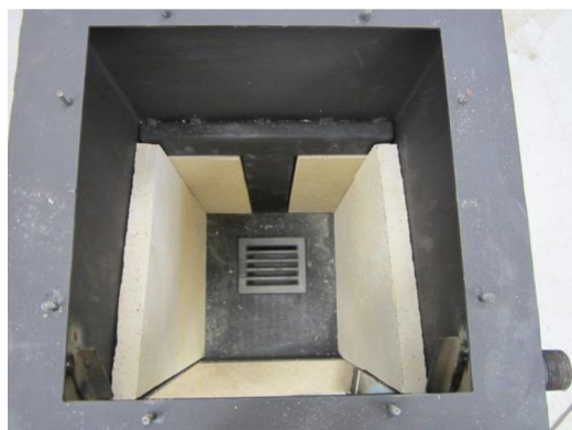
Obr. 53 Průbeh šamotování ohniště
