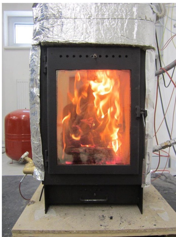
Obr. 58 Plamen při nominálním výkonu
