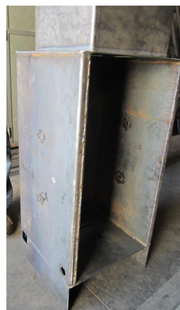
Obr. 35 Navařený teplovodní plášť
