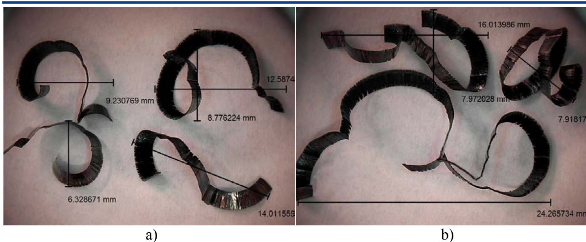
Obr. 6.6 Ukázka třísek VBD_2 po obrobení dráhy – a) 450 m až 650 m, b) 650 m až 850 m.
