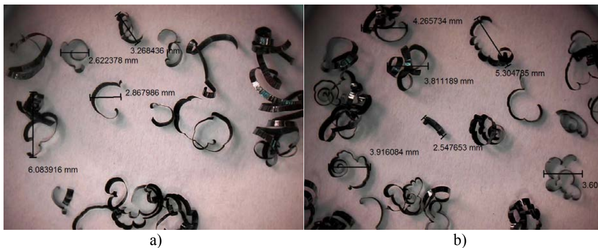
Obr. 6.1 Ukázka třísek VBD_1 po obrobení dráhy – a) 0 m až 50 m, b) 50 m až 150 m.
