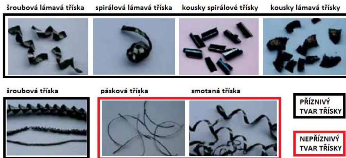
Obr. 6.7 Základní tvary třísek při soustružení [22].
