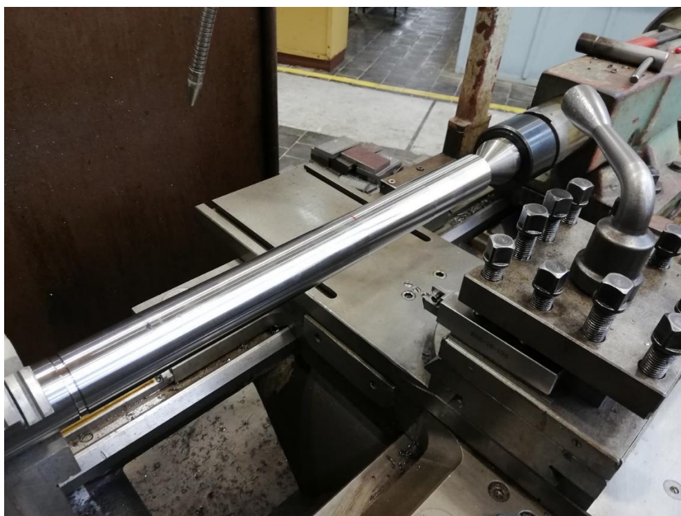
Obr. 4.6 Ukázka upnutí zkušební tyče vyrobené z konstrukční oceli 42CrMo4.
