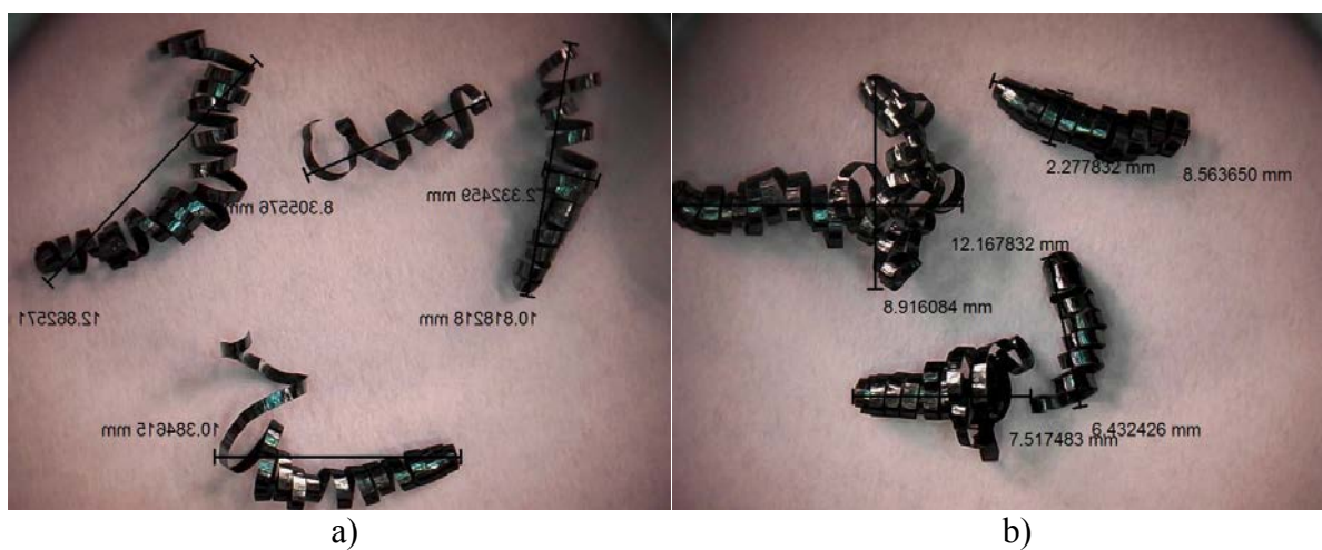
Obr. 6.3 Ukázka třísek VBD_1 po obrobení dráhy – a) 450 m až 650 m, b) 650 m až 850 m.
