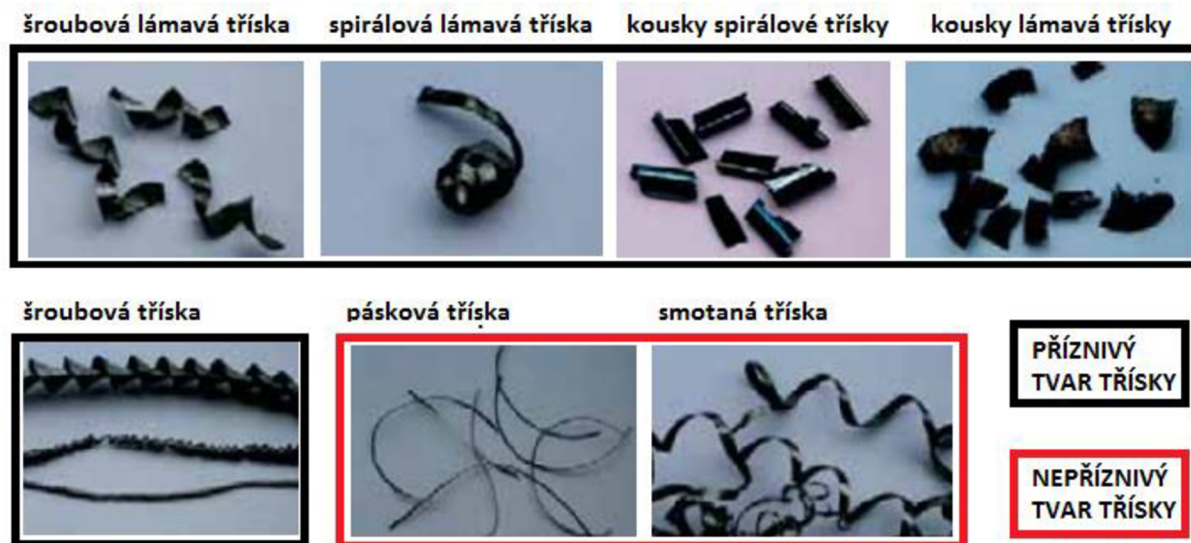
Obr. 6.7 Základní tvary třísek při soustružení [22].
