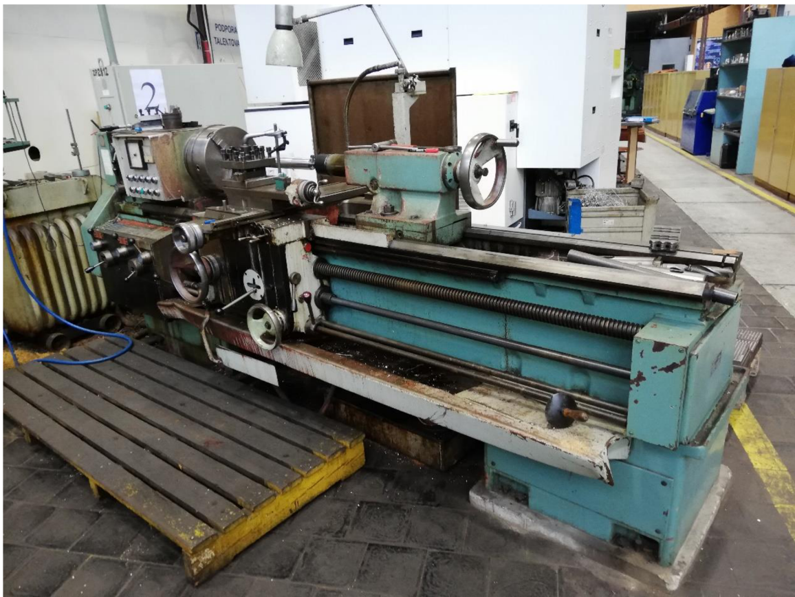
Obr. 4.7 Univerzální hrotový soustruh SU 50 A/1500.
