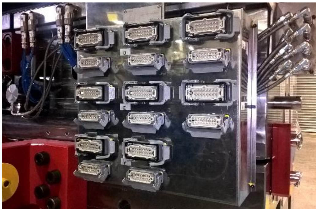
Obrázek 3.1 - Konektory horkých vtoků na vstřikovací formě
