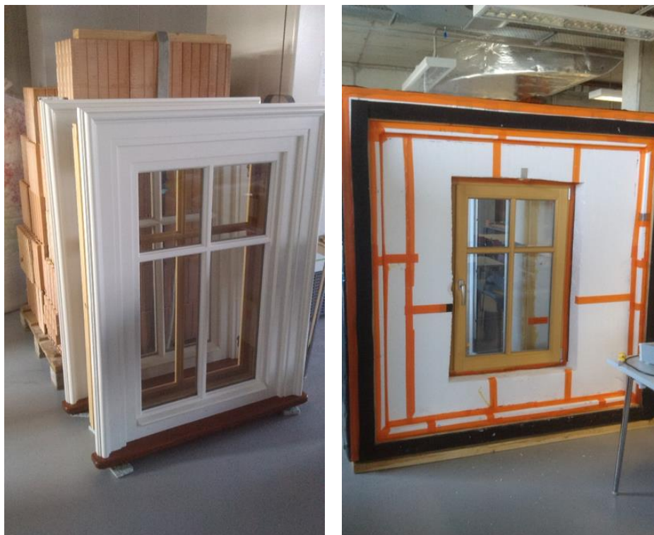
Obrázek 23 - Zabudovávání vzorku do komory
