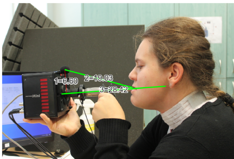
Obrázek 4.1: Určení vzdálenosti mikrofonu od úst z známých vzdáleností.
