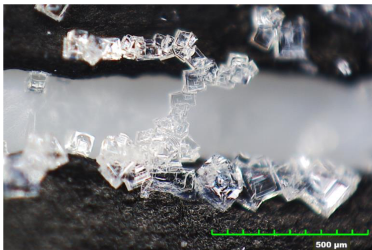
Obr. 19 Propojení dvou elektrod přes krystaly perovskitu \text{MAPbCl}_3 pod mikroskopem Hirox RH-200 Microscope
