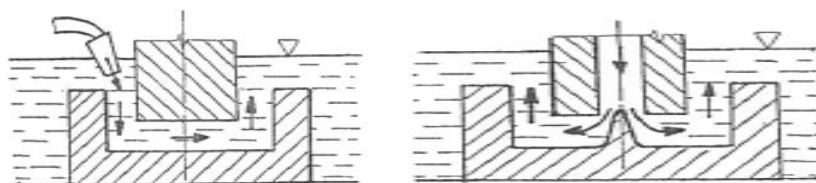
Obr. 8 Vlevo: vnější vyplachování, vpravo: tlakové vyplachování, převzato z [5]
