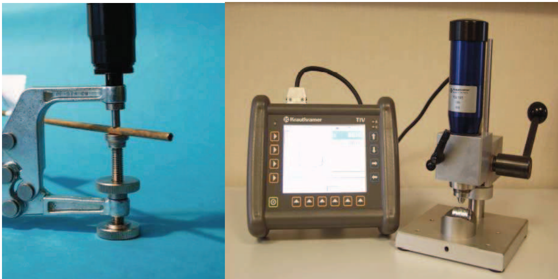
Obr. 3.4 Příslušenství k mobilním tvrdoměrům, zleva kleště pro měření malých dílů a stojánek s prizma pro měření válcových ploch (6)
