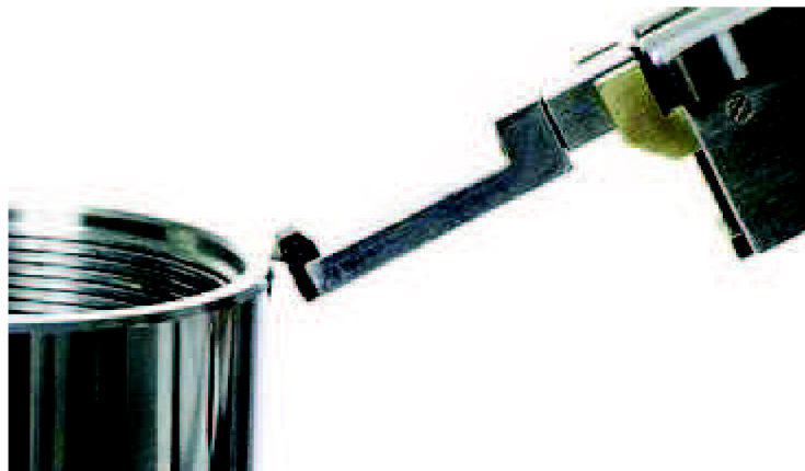
Obr. 2.3 Měření tvrdosti elektrickým odporem (9)
