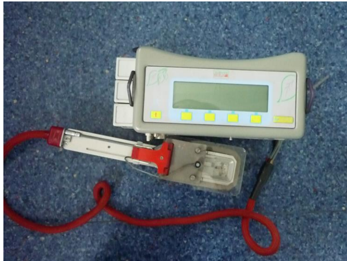
Obrázek 12: Přístroj LCpro+ pro měření fotosyntézy a transpirace
