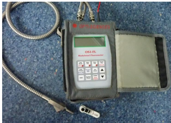
Obrázek 13: Přístroj ADC:OSI 1 FL pro získání dat fluorescence chlorofylu
