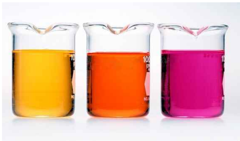
Obr.27 Přechod barev Fenolu Red ze žluté (kyselé pH) přes oranžovou (neutrální pH) po červenou (bazické pH). Efektivní rozsah Fenolu Red je u pH 6,8 – 8,4
