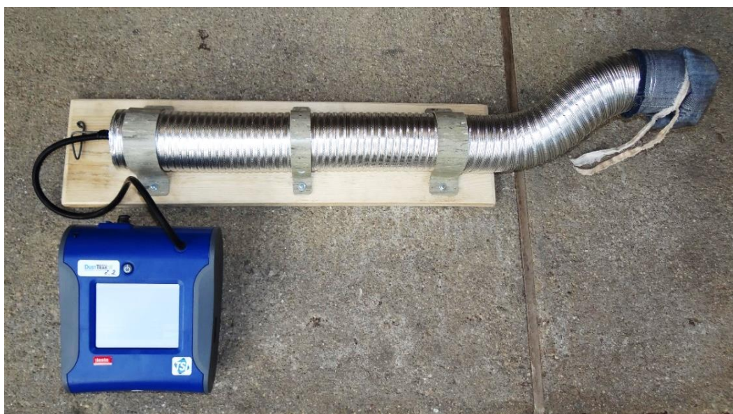
Obrázek 12 – Měřicí stanice s impaktorem zavedeným do potrubí (J.K.)
