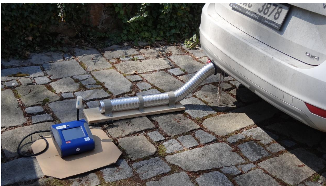
Kalibrace nuly před měřením a připojený přípravek na výfuku automobilu Škoda Yeti 2.0 TDI – EURO 6.
