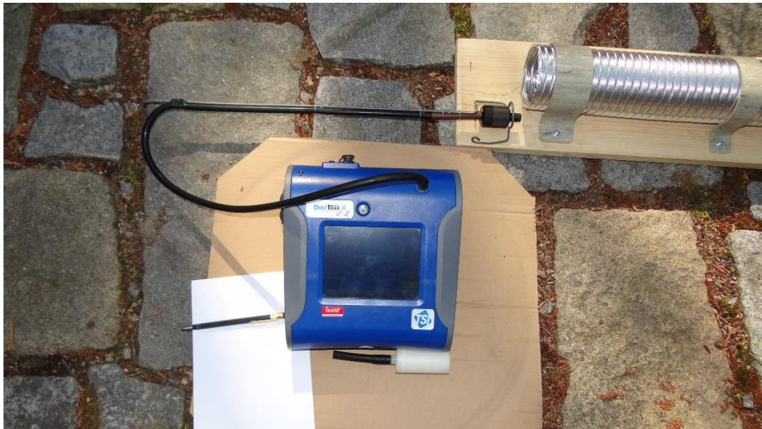
Impaktor s propojovací hadičkou a podpěrou je připraven k zavedení do potrubí.
