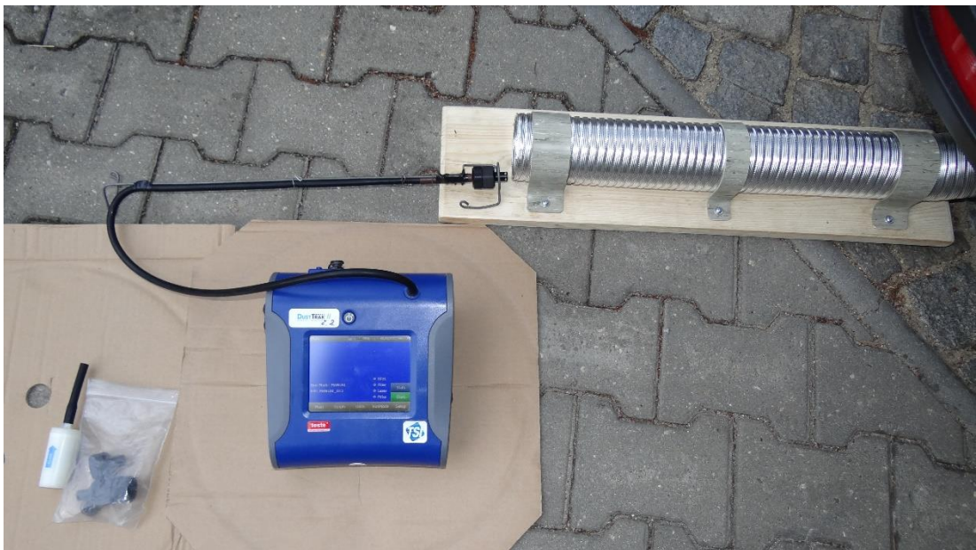
Ukončení jednoho měřicího intervalu a vyjmutí impaktoru z potrubí.
