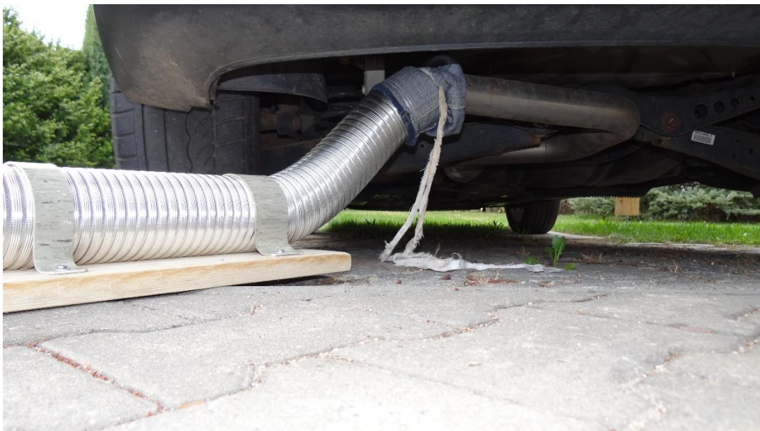
Připojení vodícího potrubí měřicí stanice a utěsnění prachovkou na konci výfuku automobilu VW Touran 1.6 TDI – EURO 5.
