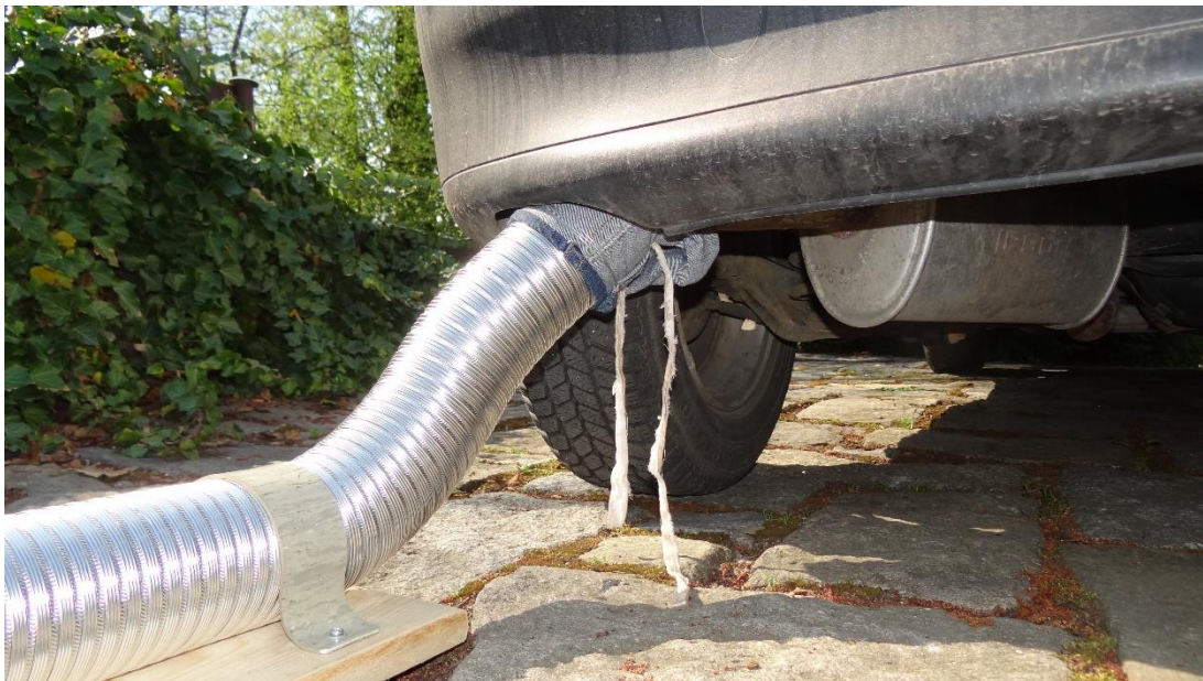
Připojení vodícího potrubí měřicí stanice a utěsnění prachovkou na konci výfuku.
