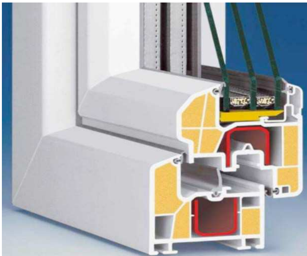
Obrázek č.19 - Detail plastového okna vyplněného tepelně izolačním materiálem Zdroj: https://publi.cz/books/92/05.html
