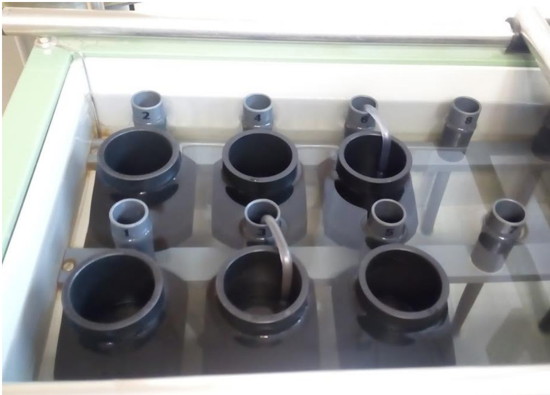
Obr. 18: Vložení násosky do držáků - měření s konstantním spádem, foto autora
